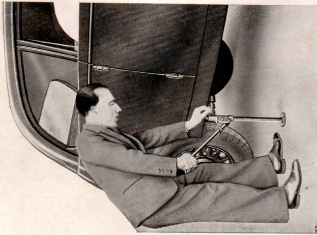
Fig. 5 — Manœuvre du cric spécial.
